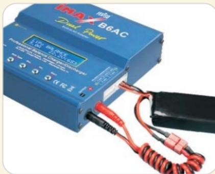
Os cabos da bateria principal devem ser conectados junto com o conector do cabo da bateria, conforme mostrado, antes de carregar a sua bateria.
